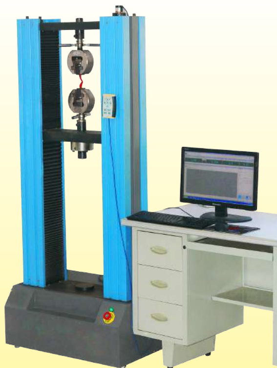
Equipement d'essai à la résistance au déchirement
